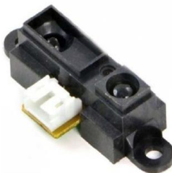
Figura 2.23 Sensor infrarrojo GP2D12
