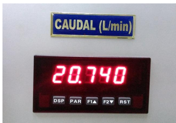
Figura 4.1: Visualización de lectura de sensor de caudal
