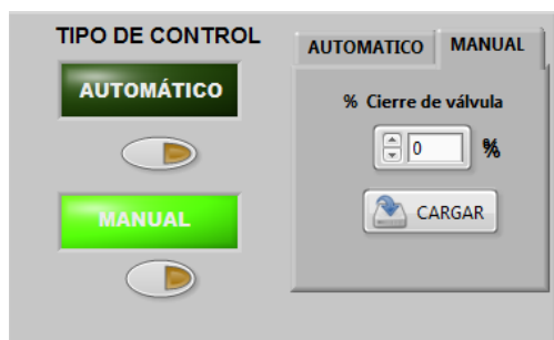
Figura 4.5: Valor de salida enviado desde scada Labview ( 0% ).
