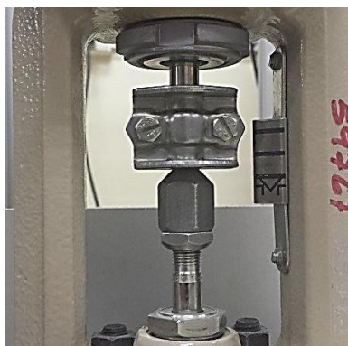
Figura 4.6: Indicador visual de posición de recorrido de válvula.
