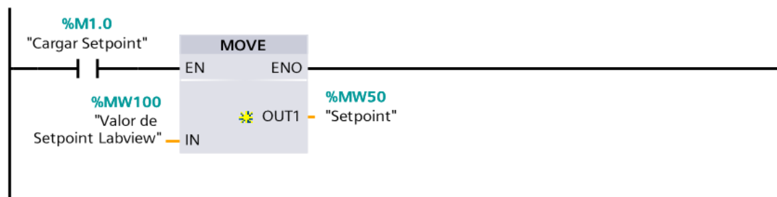
Figura 5.55: Valor Setpoint para operación remota
