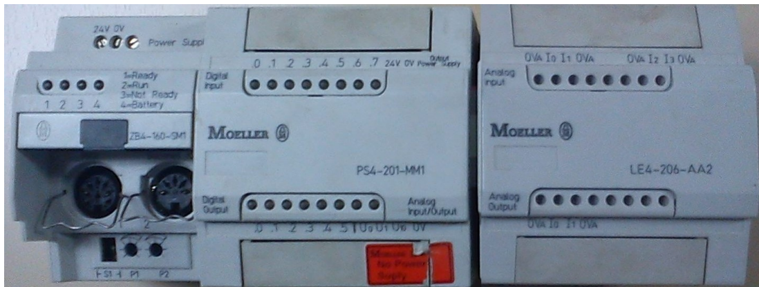
Figura 2.9: Módulos Moeller PS4-201-MM1, LE4-206-AA2
