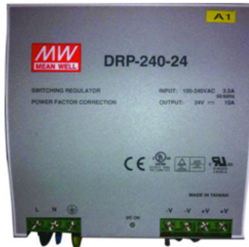
Figura 2.14: Fuente de voltaje de 24 Vdc.
