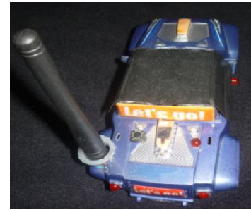
FIGURA 4.5 Estructura superior del mecanismo teleoperado, cara superior con Módulo HMTR
