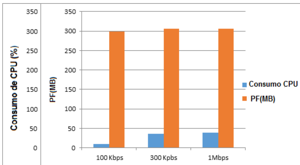
Figura 3-10 Trabajo realizado por el CPU y PF codificación H264-IPv6
