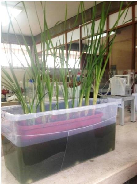
**Figura 2.14 Diseño rectangular de isla flotante de agua de la laguna de oxidación con planta totora**
