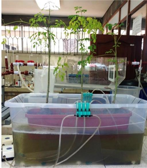
**Figura 2.15** Diseño rectangular de isla flotante de agua de la laguna de oxidación con planta moringa
