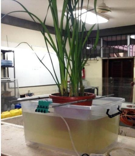
**Figura 2.13 Diseño circular de isla flotante de agua del estero salado con planta totora**
