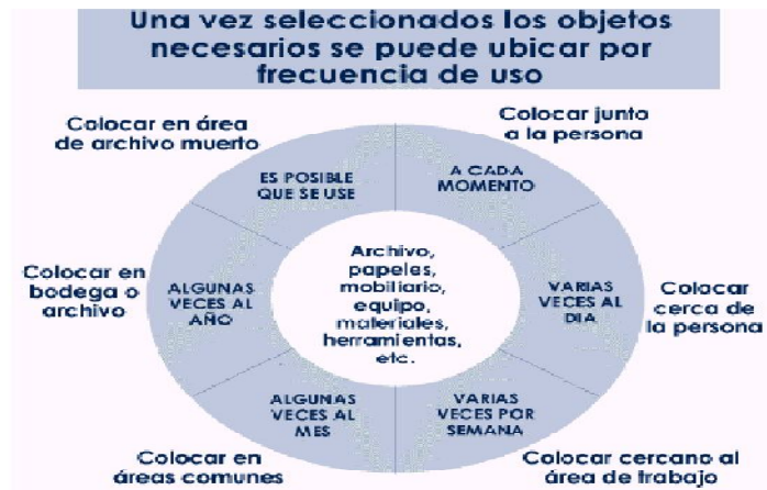
Figura 5.6 Diseño del Plan de Implementación de las 5S's "Diagrama para facilitar la Organización"
