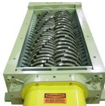
Figura 2.4 Concepto C: Rodillos dentados
