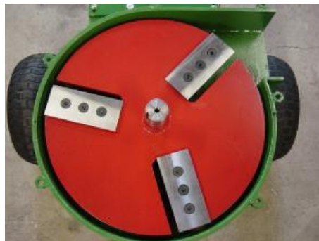
Figura 2.2 Concepto A: Cuchillas rotatorias desmontables
