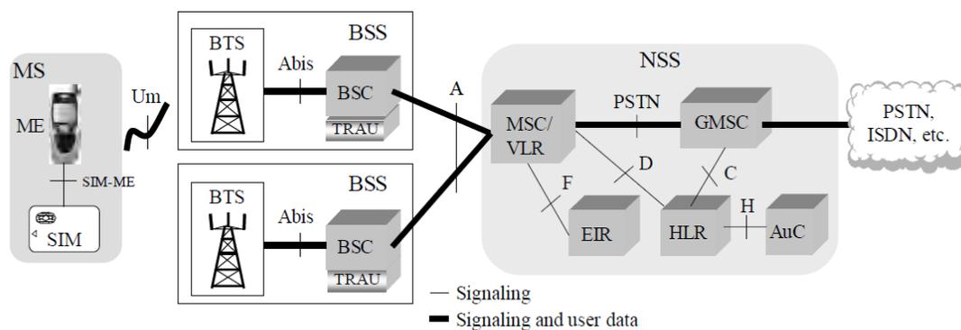
Figura 2.1: Arquitectura de la Red GSM, 2.5G (GPRS + EDGE).
