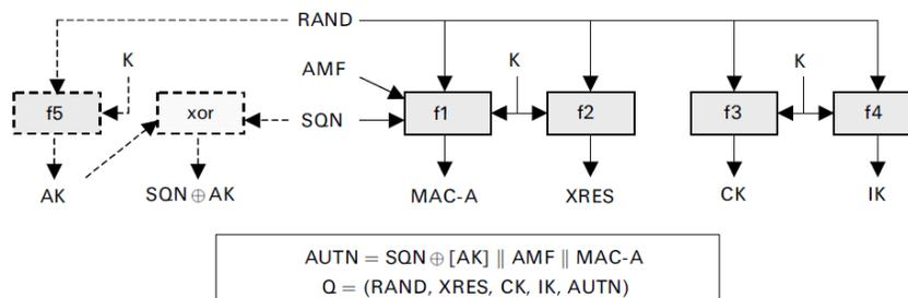
Figura 4.1: Generación de los vectores de autenticación en el AuC
