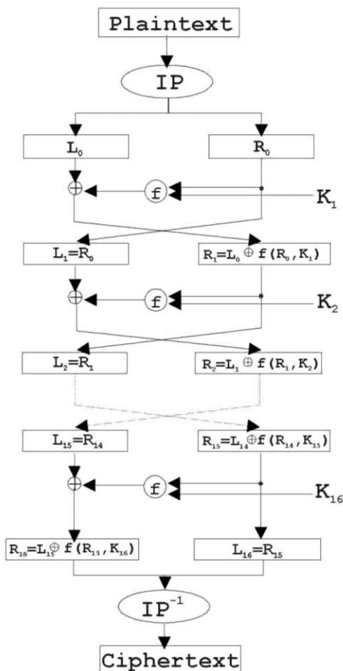
Figura 3.7: Estructura DES (16 rondas)
