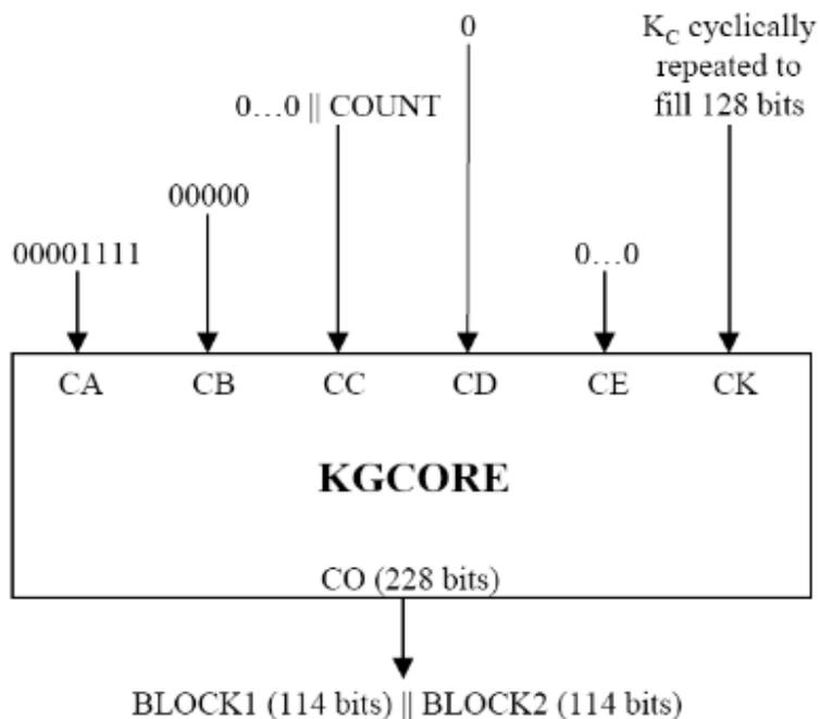
Figura 3.9: Algoritmo de cifrado de flujo A5/3.
