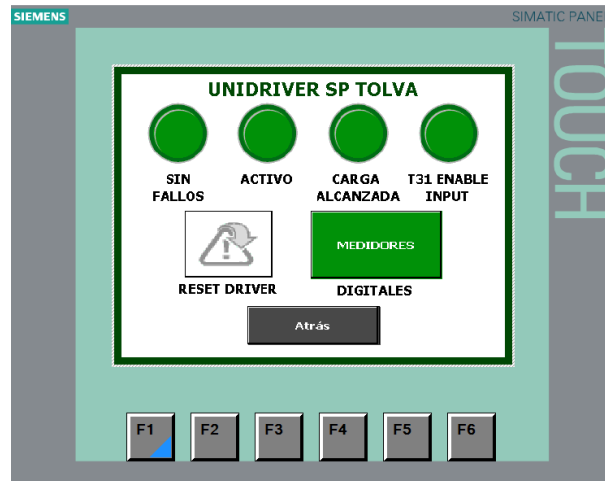
Fig. 7.28. Ventana DRIVE TOLVA DOSIFICADORA.
