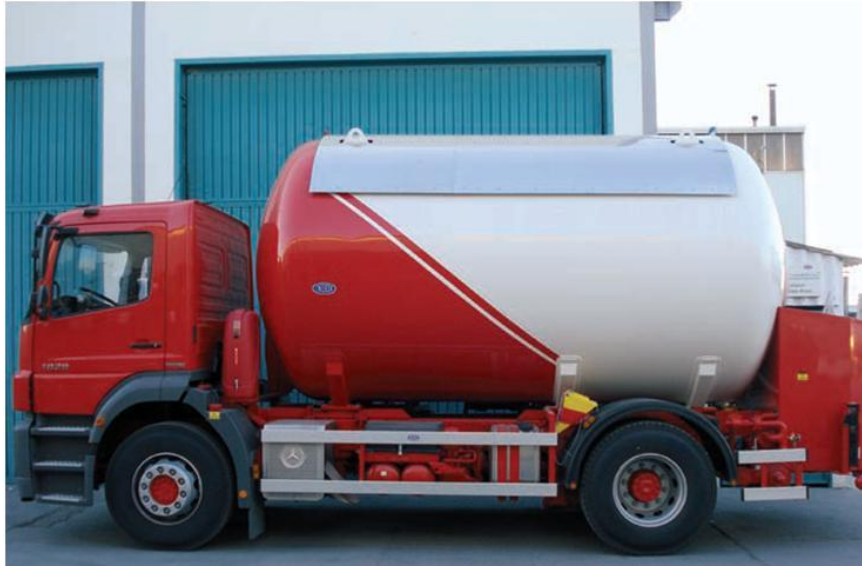
Figura 2.11: Cisterna de Abastecimiento de GLP
