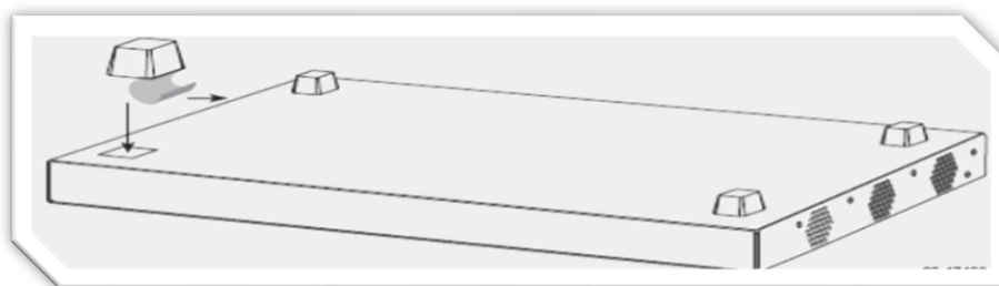
Figura 4. 1: Instalación en plataforma
