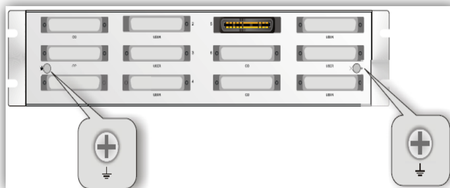
Figura 4. 10: Puesta a tierra del splitter RU-ST 7324
