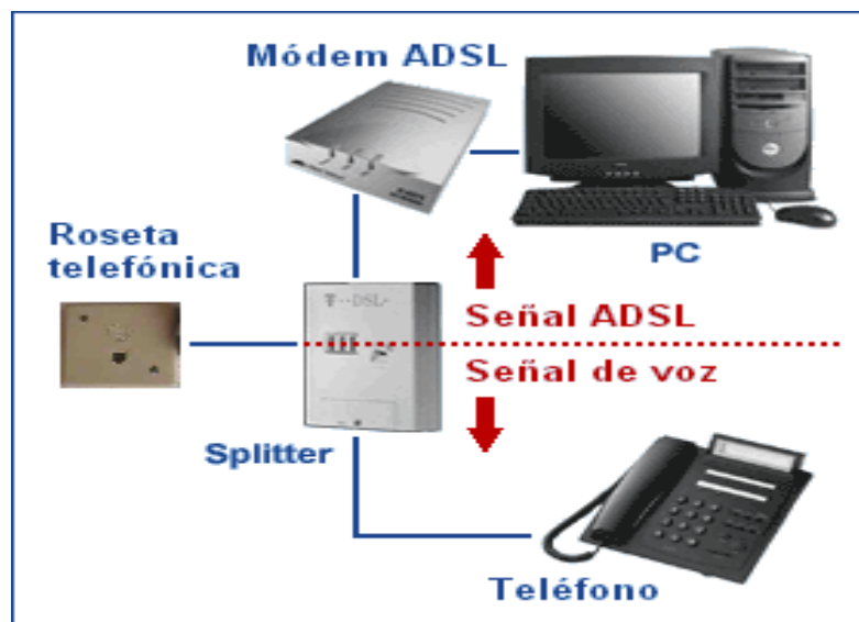
Figura 4.- Uso splitter para evitar atenuación [5]
