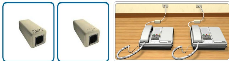
Figura 19.- Rol del Microfiltro de un puerto [24]
