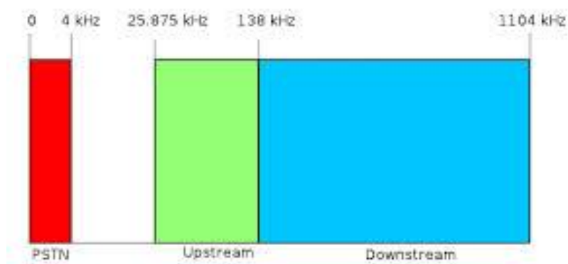
Figura 2-6 División de voz y datos en el medio de transmisión [7]
