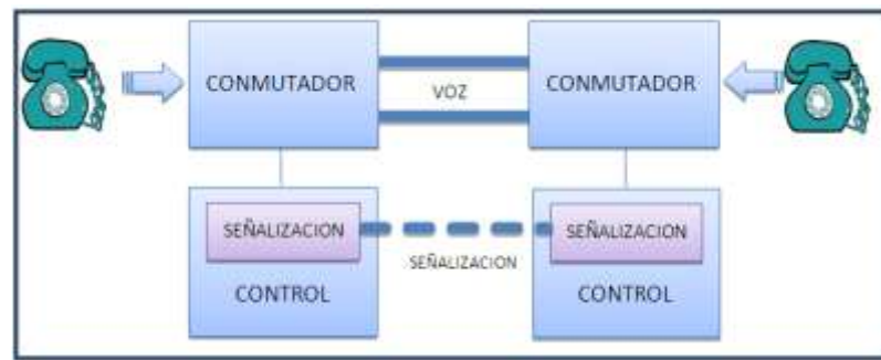
Figura 1.2 Señalización por Canal Común [1]
