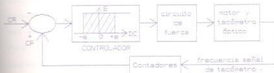
Fig 1.7 DIAGRAMA DE BLOQUES DEL SISTEMA CONTROLADOR QUE EFECTUA COMPARACION DE FRECUENCIA.
