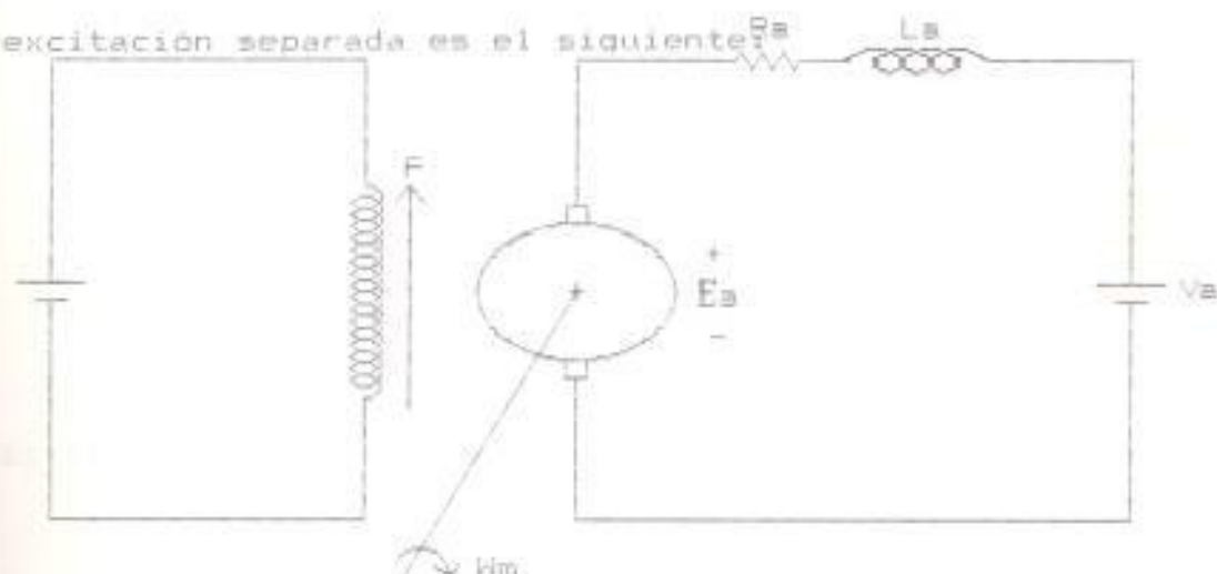
Fig. 1.5 CIRCUITO ELECTRICO DE UN MOTOR D.C. CON EXCITACION SEPARADA.
