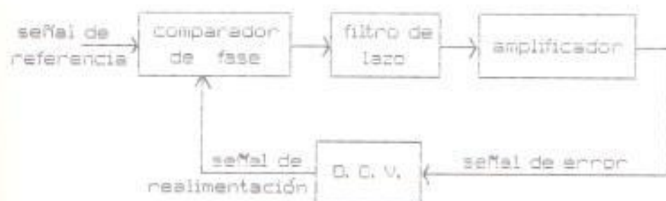
Fig. 1.1 LAZO DE ENGANCHE DE FASE CONVENCIONAL.
