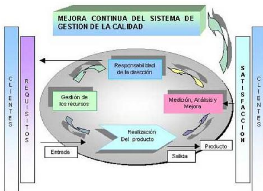
Figura 1.1. Modelo de un Sistema de Gestión de Calidad Basado en Procesos Fuente: Libro ISO 900-2000 Calidad en los Servicios Año: 2001
