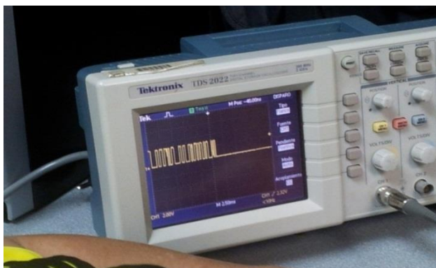
Figura No. 3.1: Determinación del Funcionamiento del Módulo mediante un Osciloscopio.
