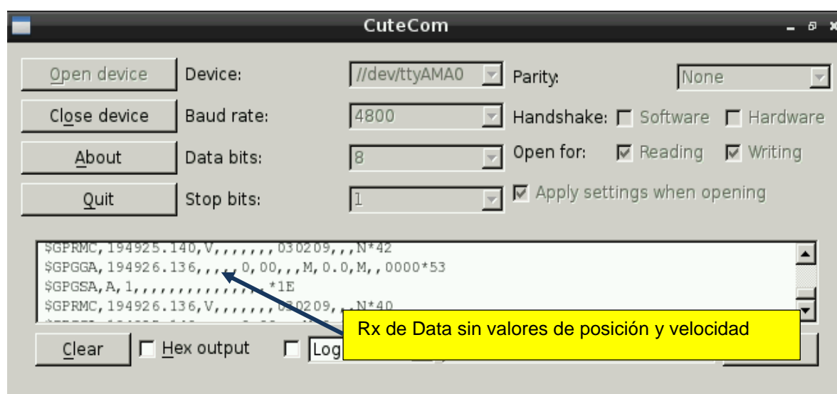
Figura No. 4.12 Adquisición de data del módulo GPS mediante el Software Cutecom.
