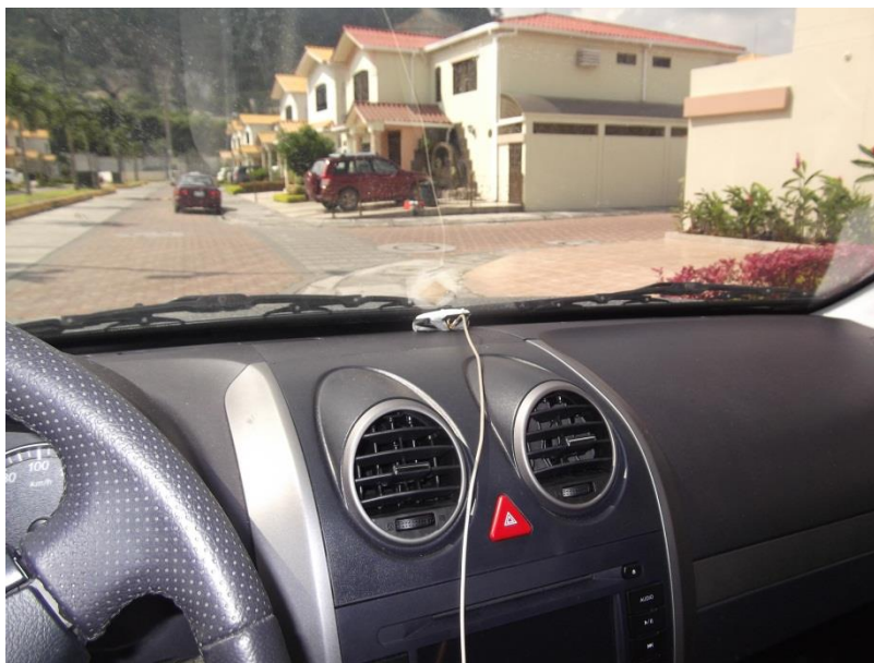
Figura No. 4.10 Instalación de antena en el interior del vehículo.
