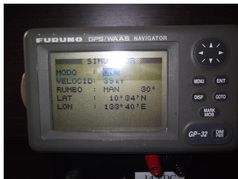
Figura No. 4.4 Pantalla para Cambio de Valores de Rumbo, Velocidad y Posición.
