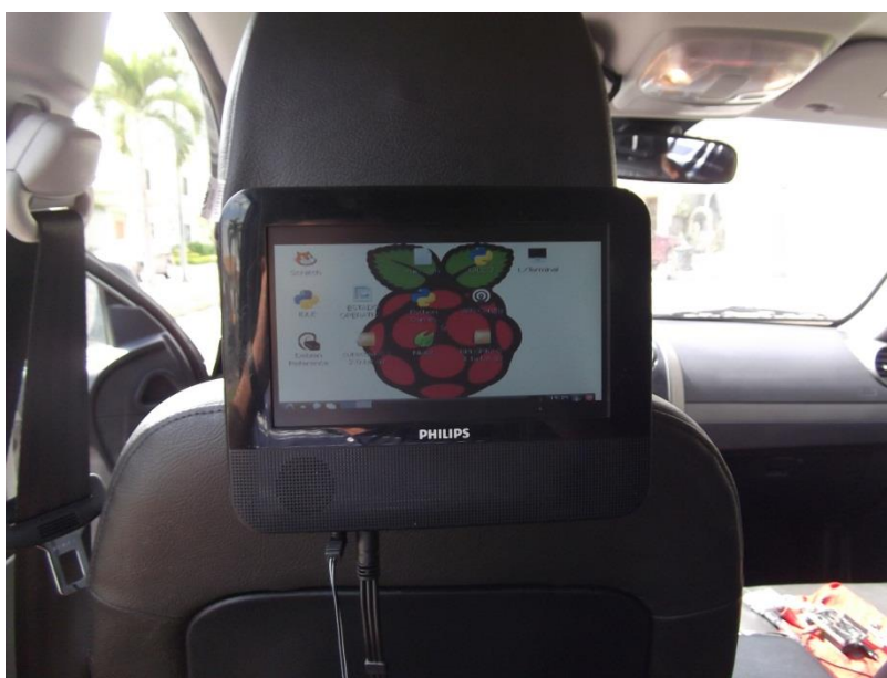
Figura No. 4.11 Instalación de display en el interior del vehículo.
