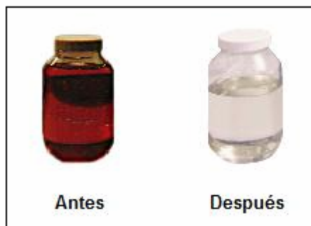
FIGURA 4.6: CAMBIO DE COLORACIÓN DEL ACEITE LUEGO DEL TRATAMIENTO CON TIERRA FULLER UTILIZANDO LA TECNOLOGÍA FLUIDEX
