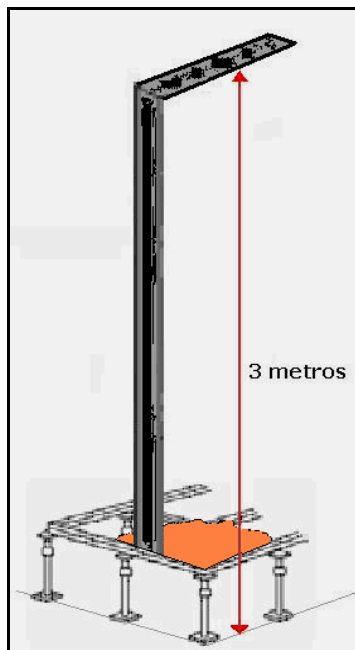
Figura 2.7 Altura del centro de cómputo.
