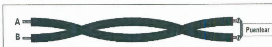
Figura 2.38 Esquema de conexión usado para medir resistencia de bucle
