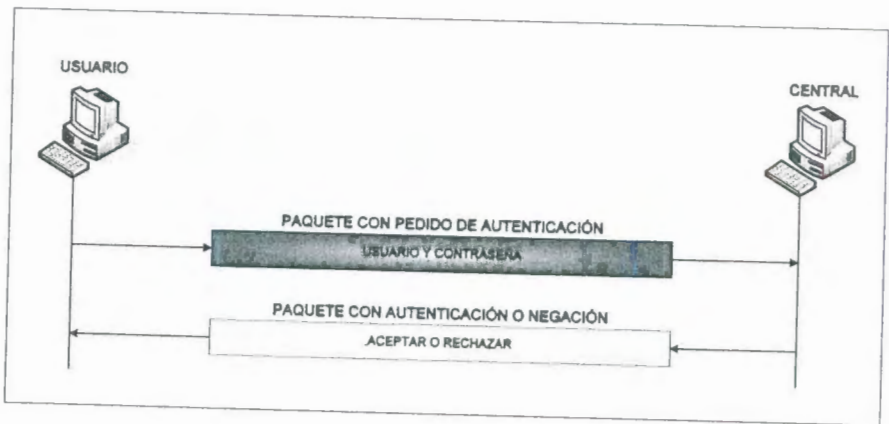
Figura 1.17 Esquema usado por el protocolo de autenticación de contraseña (PAP)
