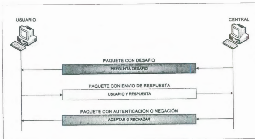
Figura 1.18 Esquema usado por el protocolo de autenticación de intercambio de señales (CHAP)
