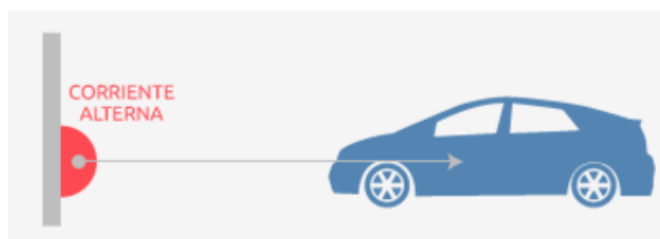
Figura 1.4: Modo 1 para carga lenta en CA
