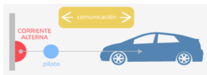
Figura 1.5: Modo 2 para carga lenta en CA
