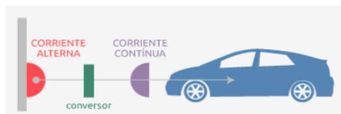
Figura 1.7: Modo 4 para carga rápida en CC
