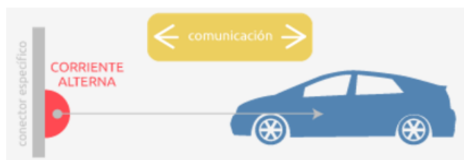
Figura 1.6: Modo 3 para carga lenta o semi-rápida. Monofásica o trifásica
