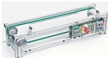
Figura 2.9: Segmento de cinta transportadora doble de 24V. [6]
