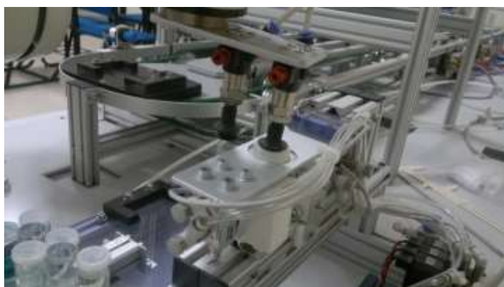
Figura 3.24: Punto de inserción de botella al descorchador.
