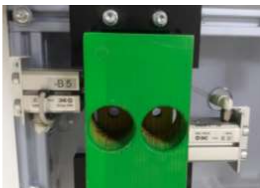
Figura 3.6: Sensor cilindro de agarre "B5" (pistón retraído).
