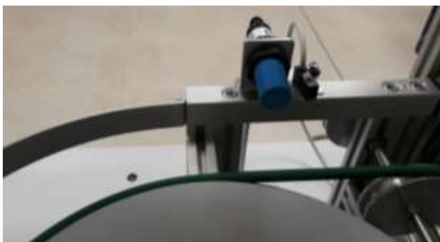
Figura 3.8: Sensores de posición (Capacitivo y Magnético).
