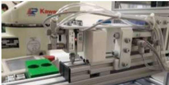
Figura 3.5: Sensor cilindro de elevación "B3" (pistón retraído).
