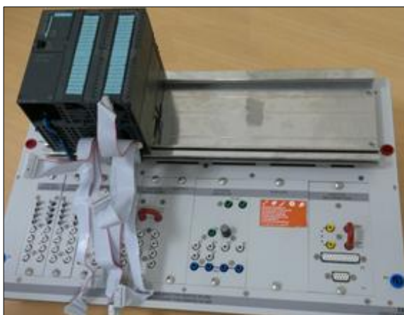
Figura 3.20: Desmontaje del tablero original
