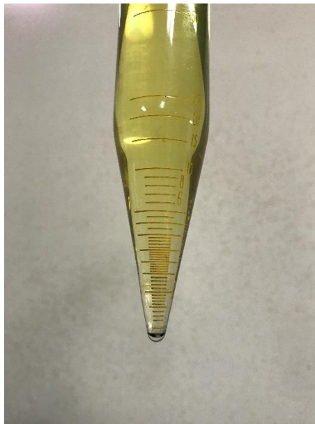
Figura B 24. Determinación de agua y sedimento en destilado 1.
