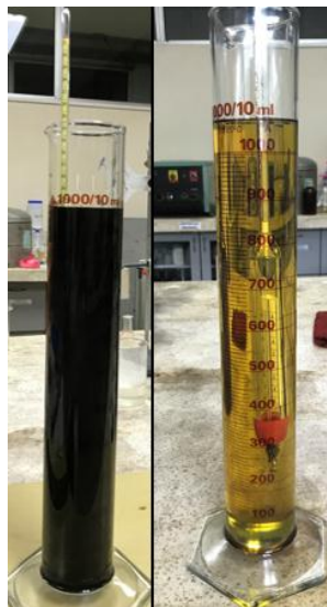
Figura 2. 6. Determinación de Gravedad API, Método de Hidrómetro.
