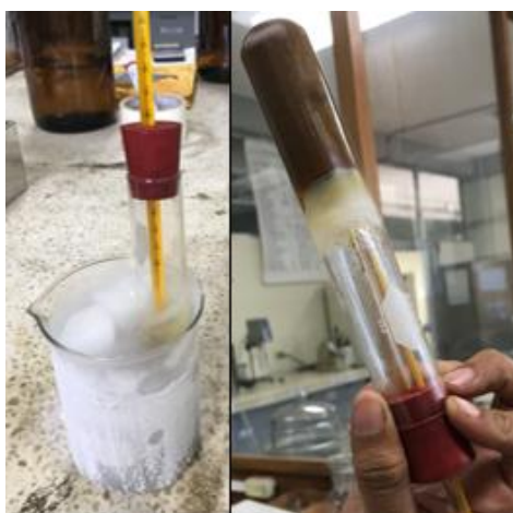
Figura 2. 12. Determinación de Punto de Fluidez.
