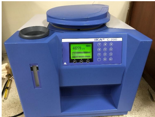
Figura B 20. Determinación de poder calorífico.
