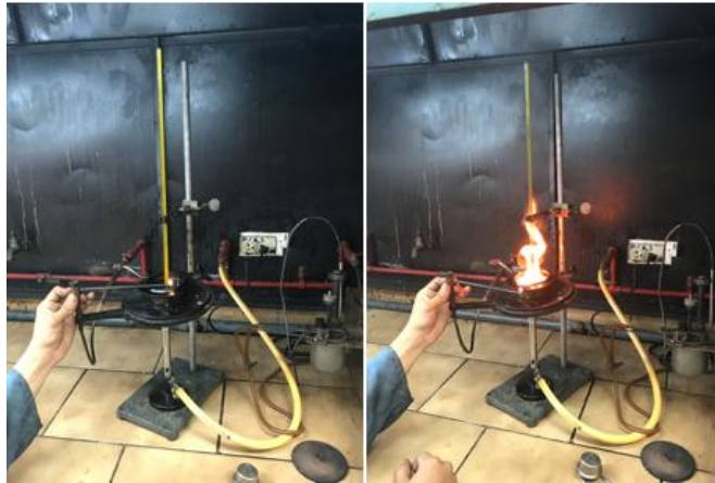
Figura 2. 10. Determinación de Punto de Inflamación.
