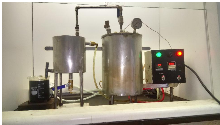
Figura B 9. Sistema del reactor piloto para el proceso de pirólisis.
