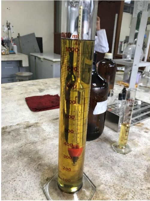
Figura B 13. Determinación de Gravedad API del producto destilado 1.
