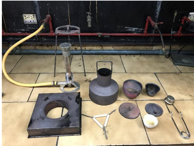
Figura B 17. Equipo completo para determinación de carbón conradson.
