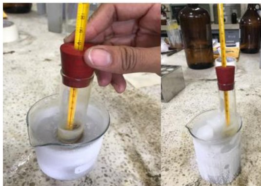
Figura B 30. Sistema de ensayo de punto de fluidez.
