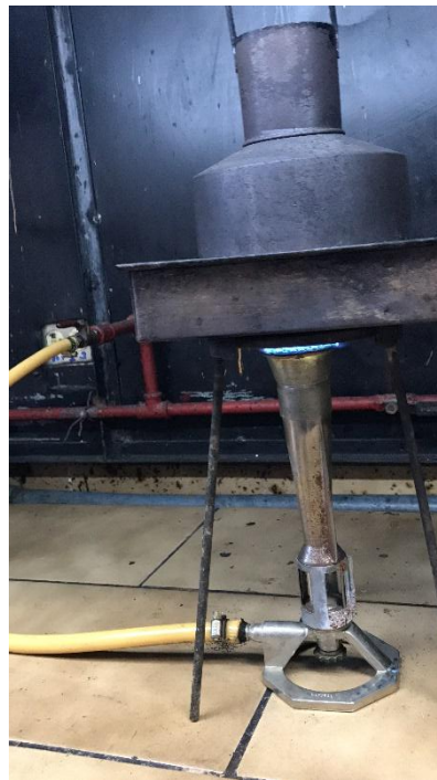
Figura B 18. Sistema para determinar el residuo carbonoso.
