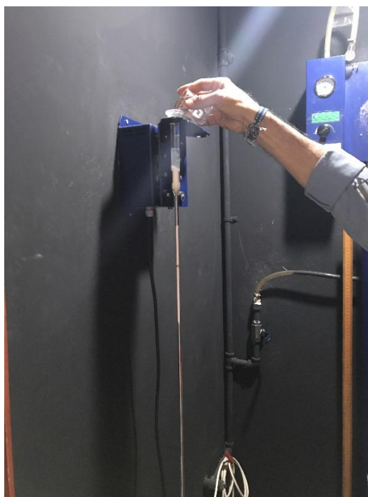
Figura B 33. Muestra añadida en la columna de cromatografía para análisis de aromáticos.
