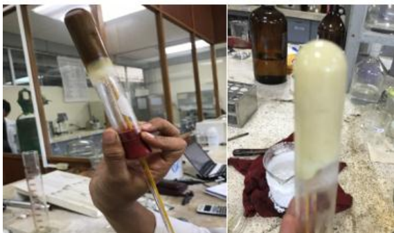
Figura B 31. Flujo estático - Temperatura de punto de fluidez.
