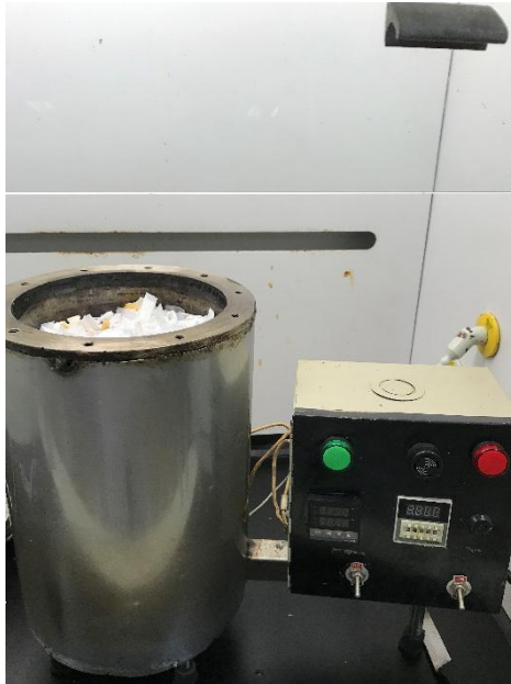
Figura B 8. Alimentación de materia prima en el reactor de pirólisis.
