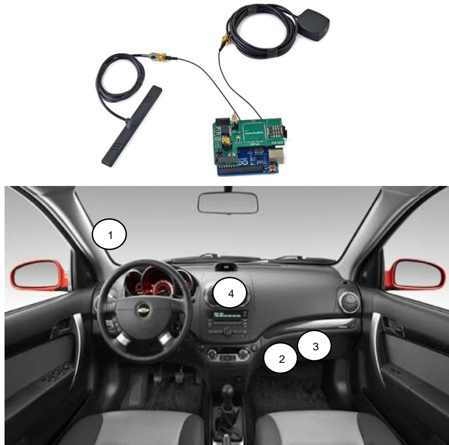
Figura 2.2: Diagrama de conexión de módulos y antenas dentro del recurso
