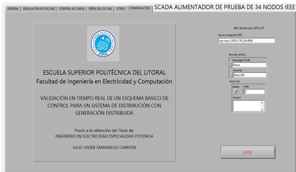
Figura 3.30. Ventana COMUNICACIÓN del sistema SCADA. Permite configurar la dirección IP del servidor, el certificado de seguridad y también tiene el botón STOP con el cuál se finaliza la comunicación entre el sistema SCADA y el servidor.
