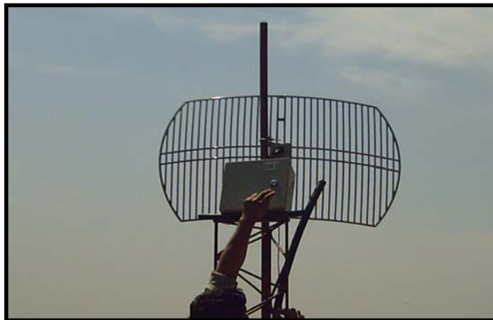
Fig 4.18 Caja donde esta situada la radio DWL 2100AP
