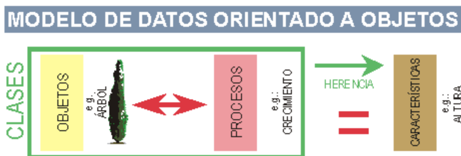
Figura 1-5 Modelo de Datos SIG Orientado a Objetos [9]
