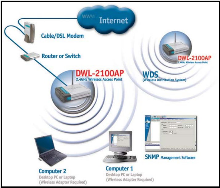
Figura 3.12. Ejemplo de conexión de un Access Point D-Link
