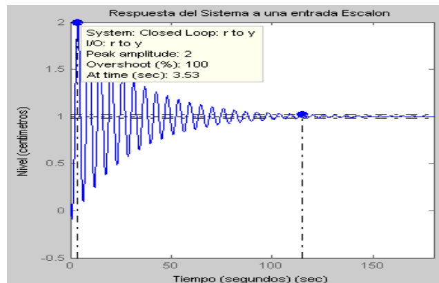
FIGURA 3.3.3.1.12. OSCILACIÓN DE LA RESPUESTA DEL SISTEMA DISMINUYENDO EL TIEMPO DE ESTABILIDAD < 8.8S.
