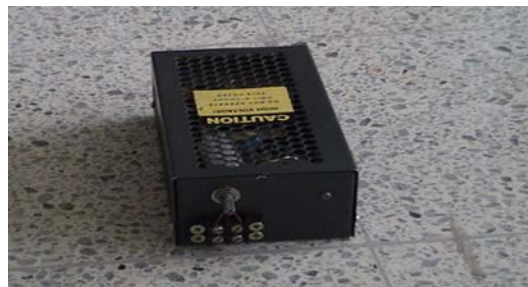
FIGURA 1.4.2.1. FUENTE DE VOLTAJE PARA EL SENSOR.
