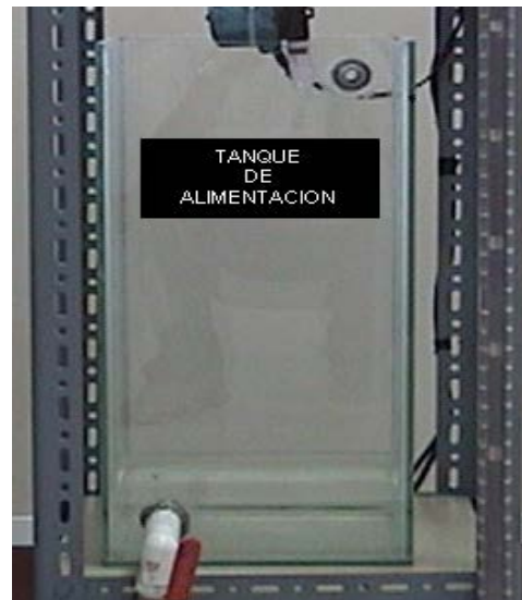
FIGURA 4.3.4.1.1 TANQUE DE ALIMENTACIÓN O SUMINISTRO.
