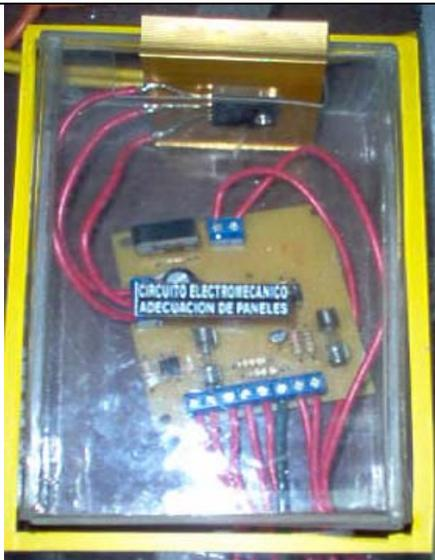
Tarjeta electrónica que realiza las adecuación de las señales que ingresarán al sistema lógico para evitar daños en la misma por sobre voltaje y el sistema de potencia de las señales que salen del computador al campo para aumentar a la corriente necesaria
