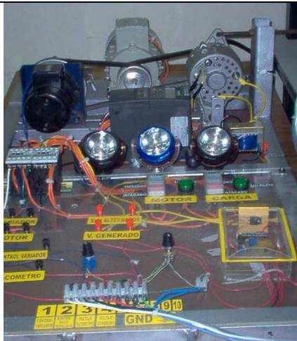
Sistema físico completo, donde las señales de control del sistema lógico (computador), logran dar movimiento a todos estos equipos que nos permite generar de voltaje y frecuencia que deseamos
