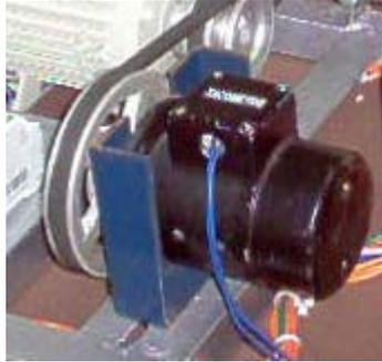
Tacómetro del sistema, encargado de enviar una señal eléctrica proporcional a la velocidad del sistema.
