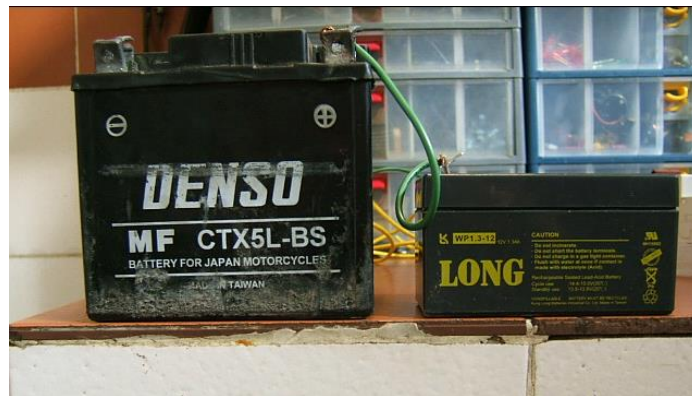
Fig. 3. 29 Baterías Usadas en el Bus
