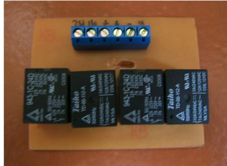
RELES PARA CONTROL DEL MOTOR DEL PANTO
