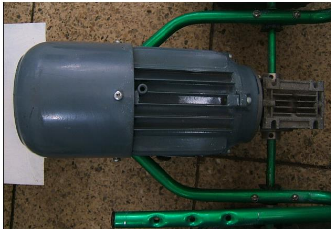
Fig. 3. 12 Vista del Motor y su Reductor
