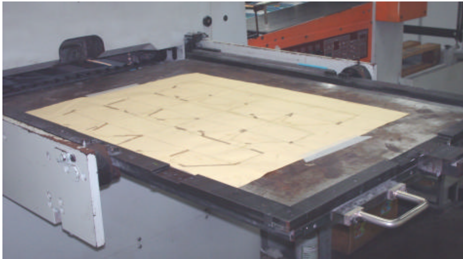
FIGURA 3.5 RAMA PORTA TROQUEL CON LA COPIA CONTRA TROQUEL REGISTRADA AL TROQUEL A UTILIZAR.
