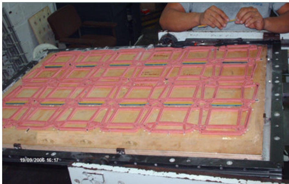
FIGURA 3.2 RAMA PORTA TROQUEL PREVIO AL DESMONTAJE DEL TROQUEL.
