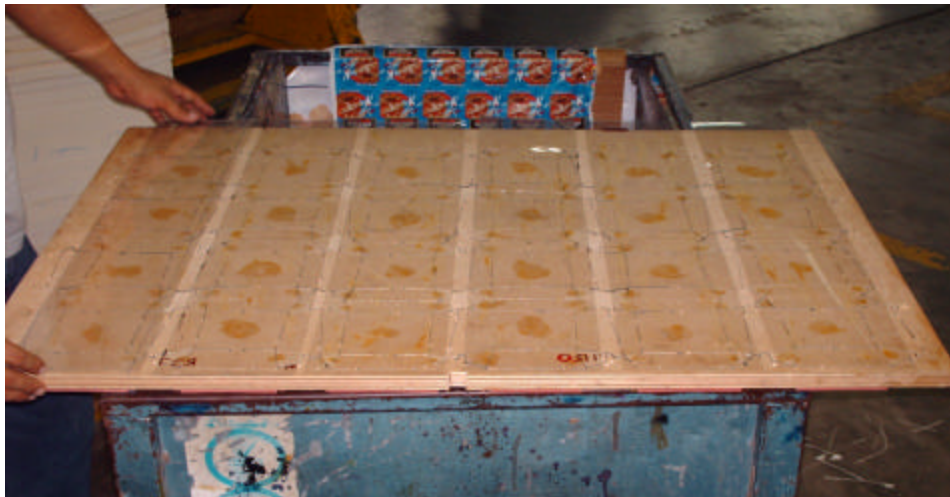
FIGURA 3.3 VISTA POSTERIOR DEL TROQUEL PREPARADO CON EL ACETATO EN LAS CUCHILLAS DE MENOR ALTURA.
