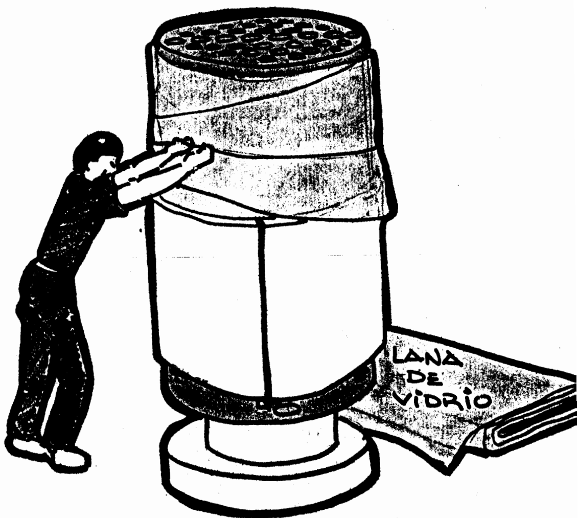
AISLAMIENTO TERMICO DEL CALDERO
