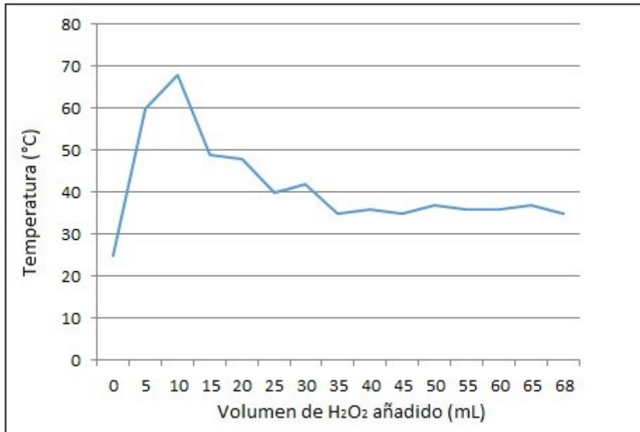
Gráfico 3.11. Curva temperatura vs. volumen añadido de H 2 O 2 de la prueba 4.1 MIXTA 1- tercera réplica.
