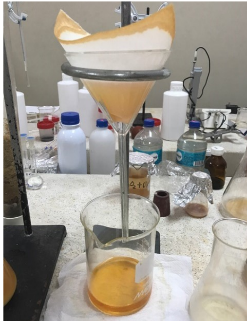
Figura 2.12. Sistema de filtración
