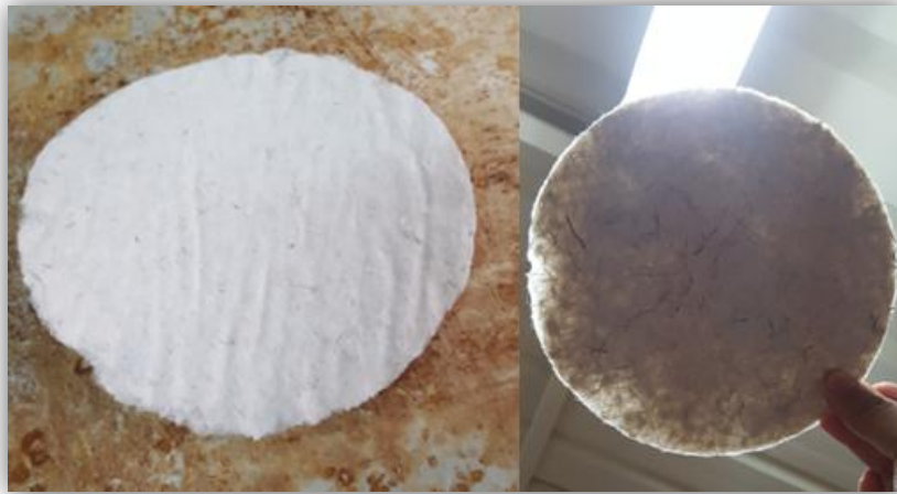
Figura 42. Formación de hoja de la segunda corrida sin refinar
