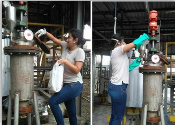
Figura 37. Alimentación del digestor
