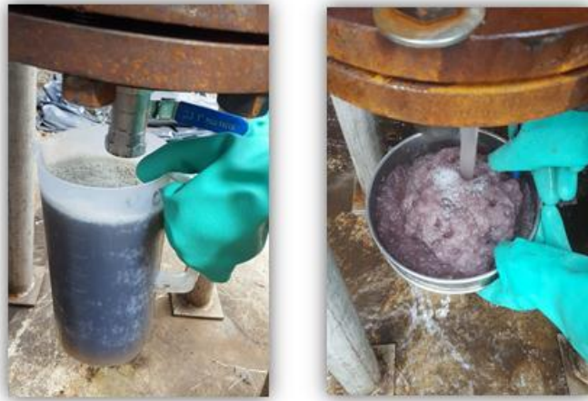
Figura 40. Descarga del Digestor
