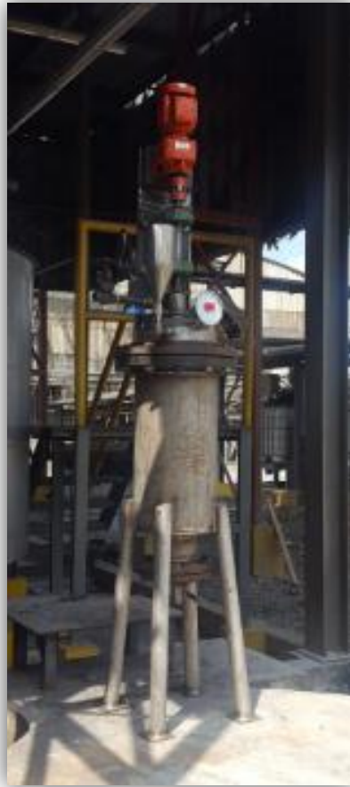
Figura 23. Digestor Piloto de Papelera Nacional S.A.
