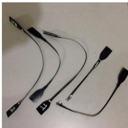
**Figura A. 9. Probetas del balde 50% B + 50% scrap**
