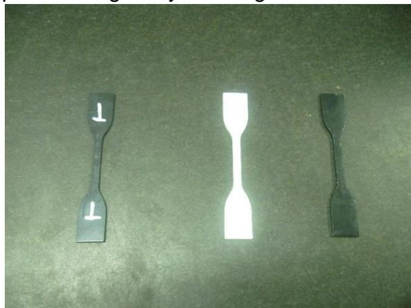
**Figura 2. 7. Probetas troqueladas de los productos (baldes) 80% scrap + 20% A, 100% C, 50% B + 50% scrap**
