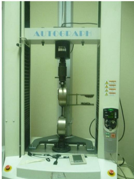
**Figura 2. 6. Máquina Universal para ensayos de tensión. LEMAT**
