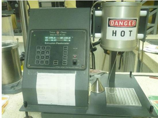
**Figura 2. 4. Material bajo análisis saliendo del cilindro para ser cortado y pesado**
