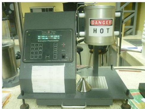
**Figura 2. 3. Plastómetro, Laboratorio de Procesamiento de plásticos, ASEPLAS**
