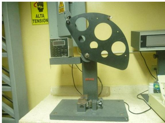
**Figura 2. 5. Impactómetro, Laboratorio de Procesamiento de Plásticos, ASEPLAS**
