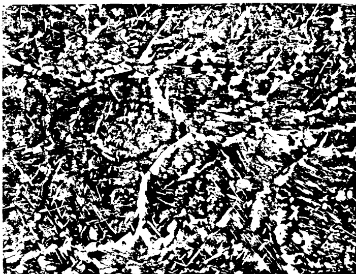
Fig. 14.- Microestructura de la sección transversal del material base del acero SAE-1030
