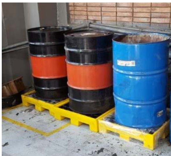
Ilustración 14 - Tanques de desechos peligrosos con pallets contenedores de derrames.
