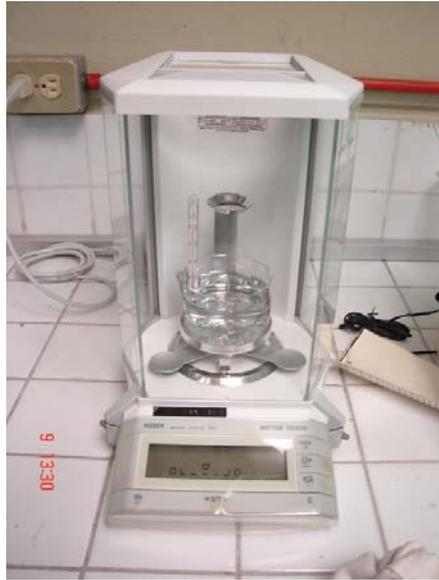
**FIGURA 3.1 MEDIDOR DE DENSIDAD**
