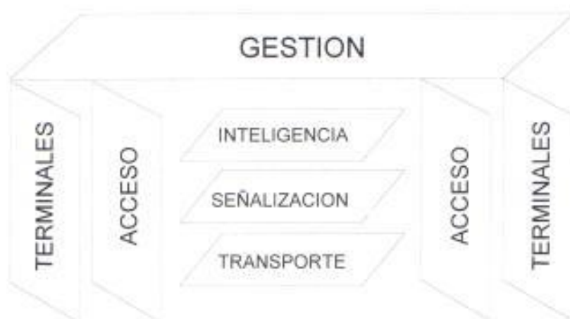
FIG 1-1 Arquitectura de una Red Telefónica
