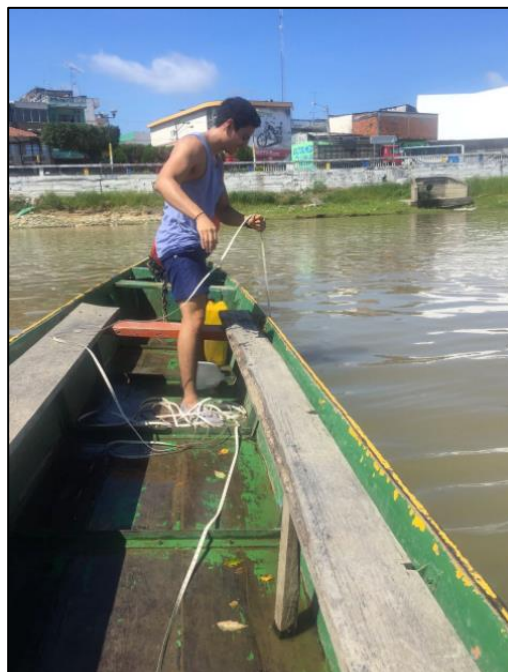
Figura 4.2 Batimetría realizada con cinta y canoa. Fuente: Mendoza, C., Torres, C., 2017.
