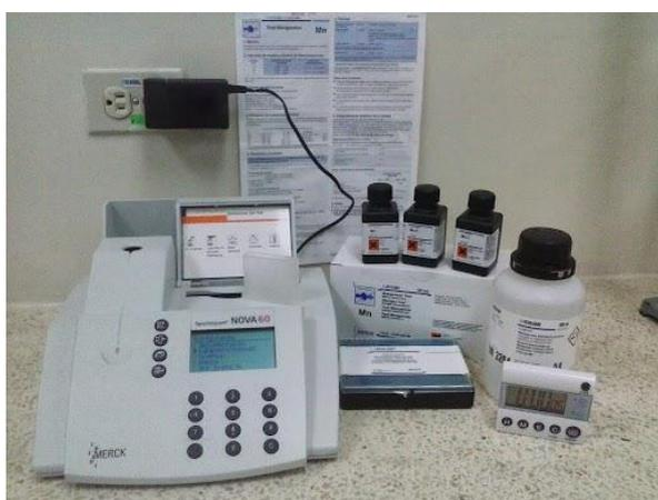
**Figura 8.- Fotómetro NOVA60, Kit de medición de Manganeseo y solución Standard de 1000 ppm de Mn. MERCK. Laboratorio de Medio Ambiente 2. DCQA-ESPOL**
