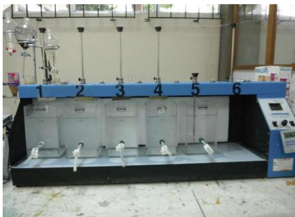
**Figura 4.- EQUIPO: PB-700 TM JARTESTER, Laboratorio DCQA-ESPOL.**
