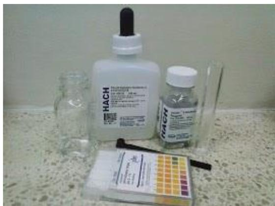
**Figura 7.- Kit de medición de dureza y tirillas de pH.**
