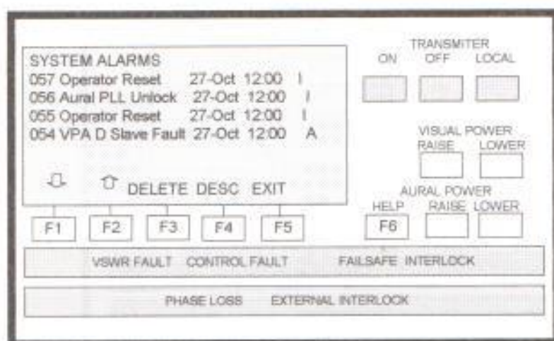
Figura 4.4 Sistema de Alarmas
