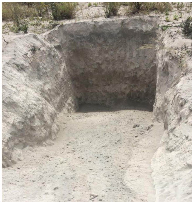
Figura 3.6 Vista de Calicata Fuente: Galarza, J., Ocampo, A., 2017
