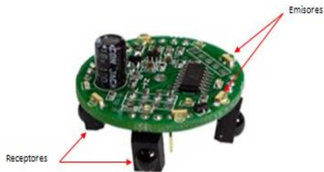
Figura 2.6.- Ubicación de los emisores y receptores
