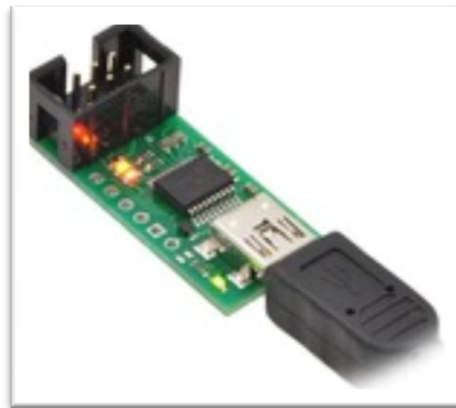
Figura 2.12.- Pololu USB AVR Programmer
