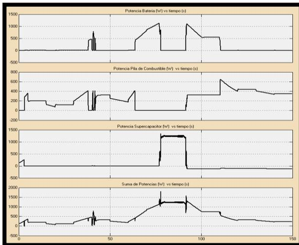
**Figura 16.** Potencia batería + pila de combustible+supercapacitor
