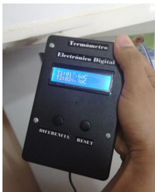
Figura 14. Prueba Física de la Toma de Temperatura en dos gradientes distintos.
