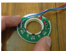
Figura 2. Sensores de efecto Hall.
